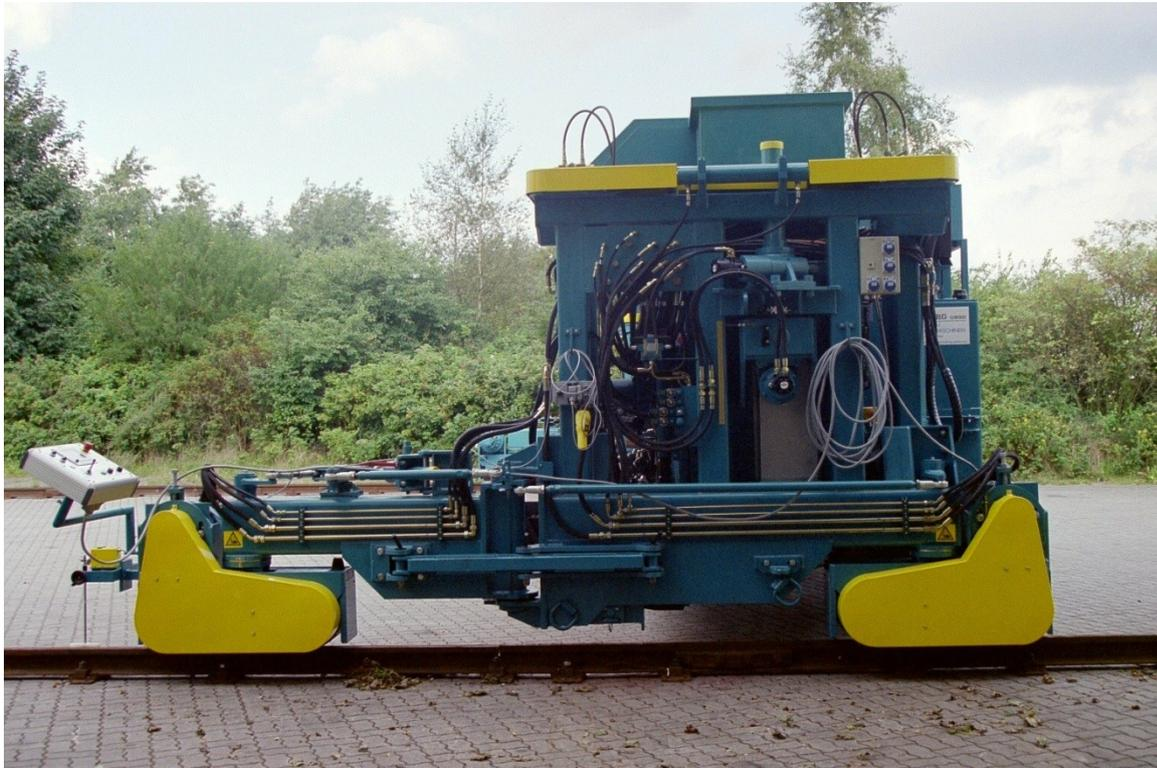
Bohle KBR 140 Seitenteil mit lenkbarem vorderem Laufwerk
