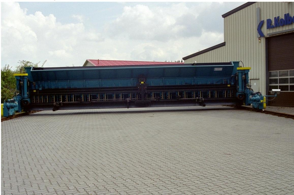
Bohle KBR 140 bei 13,875 m Einbaubreite mit Splitt Fassungsvermögen 1,2 m<sup>3</sup> / m
