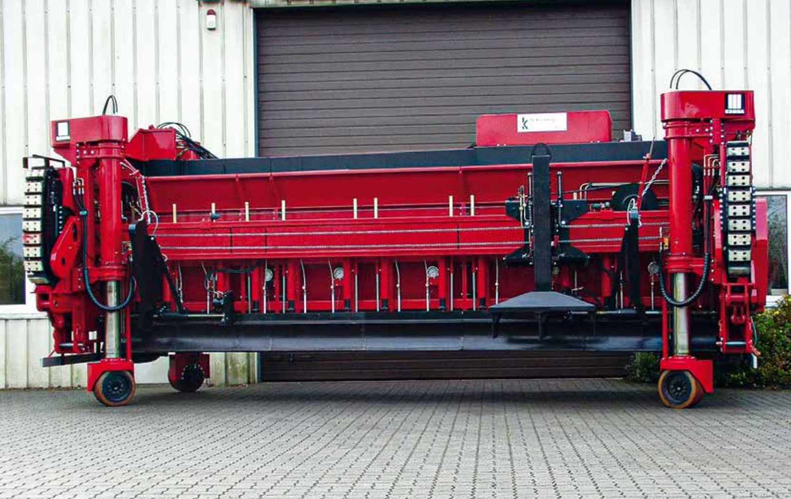
■ Gietasfaltfinisher KBR 75 op uitgeschoven kolomchassis, klaar om geladen te worden
